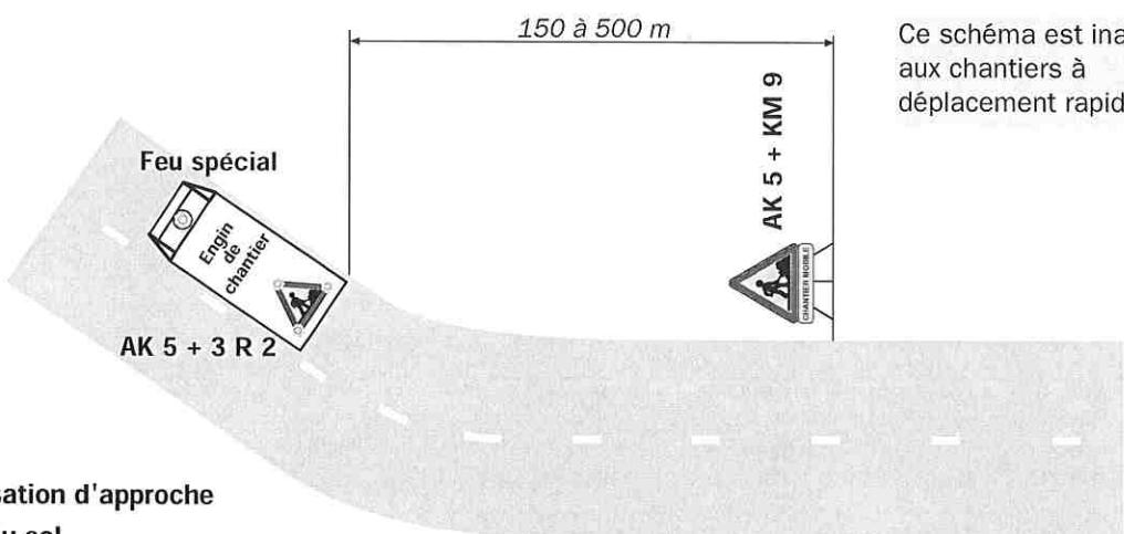
Ce schéma est inadapté aux chantiers à déplacement rapide
